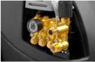
Motobomba profesional con motor de 4 polos (1400 rpm) y bomba lineal autocebante: la baja velocidad de rotación alarga significativamente la vida útil de los componentes internos de la motobomba, garantizando una mayor eficiencia y silencio
